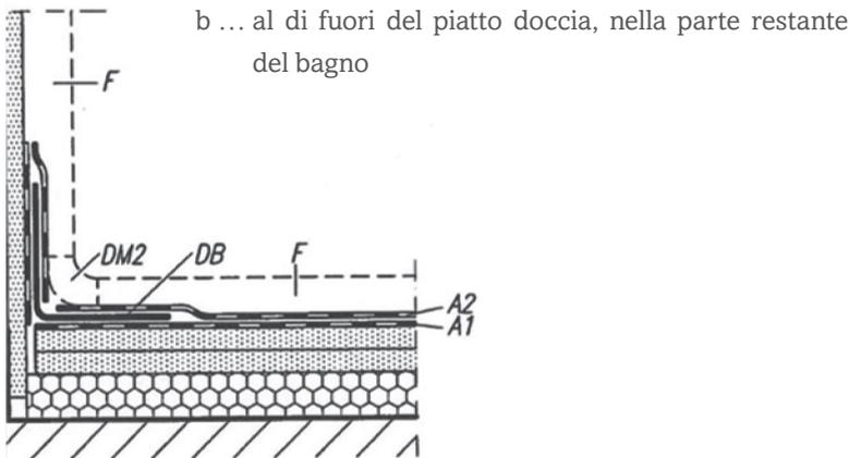
Fig. 12 – Impermeabilizzazione dell'area non interessata da proiezione d'acqua. Tralasciare l'impermeabilizzazione della parete soprastante. [7.12]
